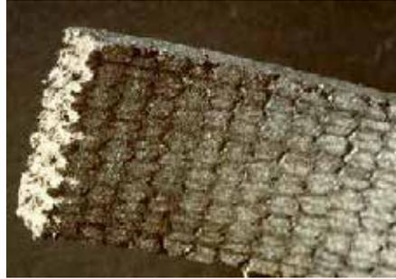
Con amianto friabile, si indicano manufatti in cui l'amianto non è legato stabilmente al cemento, ma ad una matrice facilmente sgretolabile (coibentazioni di tubazioni, rivestimenti di pareti a spruzzo), quindi un materiale che può essere facilmente ridotto in polvere con la semplice pressione delle dita.
